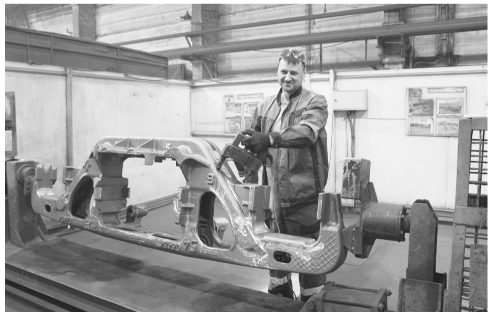
► Дефектоскопист по магнитному и ультразвуковому контролю ЛНК Андрей Колесников проводит магнитопорошковый контроль и ультразвуковую толщинометрию детали Рама боковая
